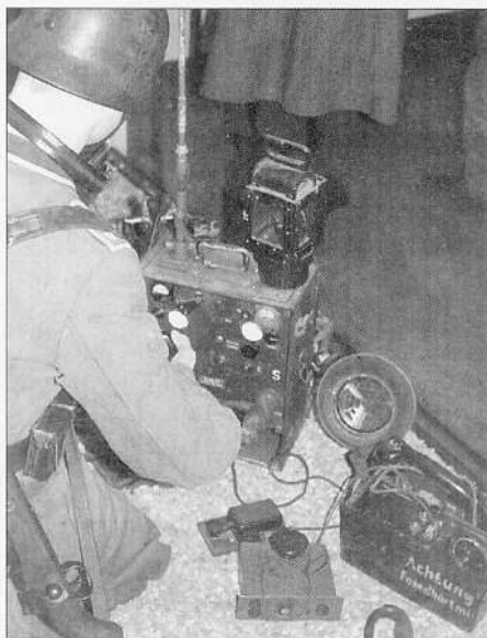
Foto onder: Zo ging dat vroeger: een Duitse soldaat bedient de Torn Fu.d2 zendontvanger.
